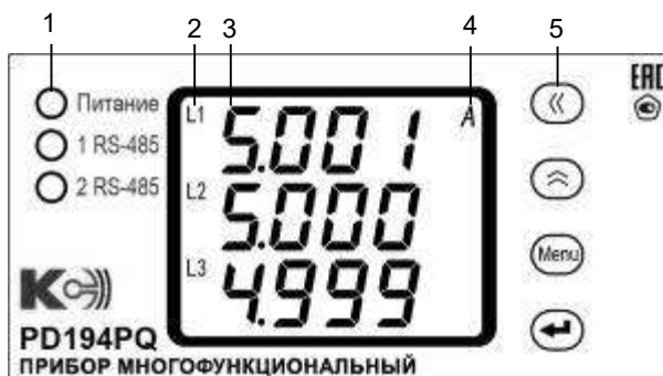
Рисунок 4.5 – Лицевая панель прибора PD194PQ с ЖК-индикатором исполнения на DIN-рейку (типоразмер 7)
