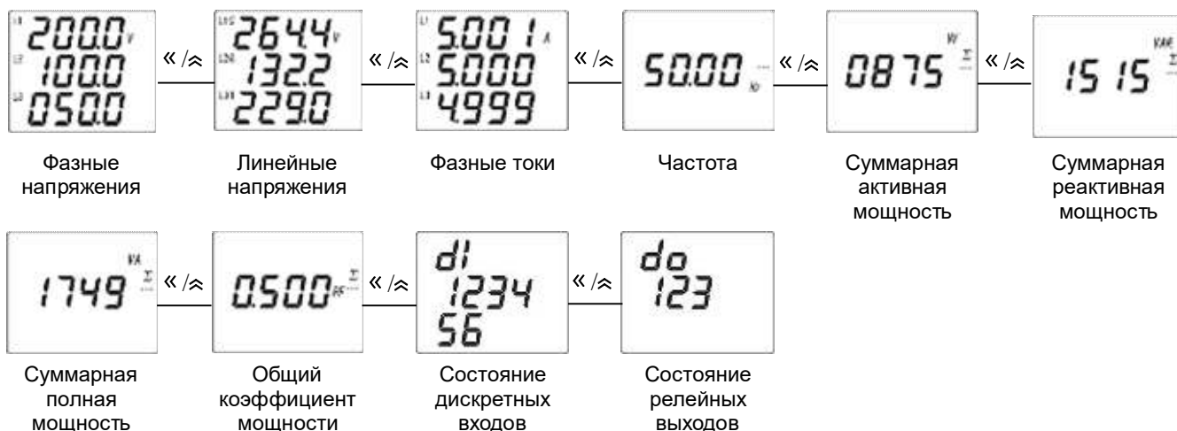
Рисунок 4.15 – Индикация показаний на приборе исполнения на DIN-рейку с ЖК-индикатором, дискретными входами и релейными выходами
