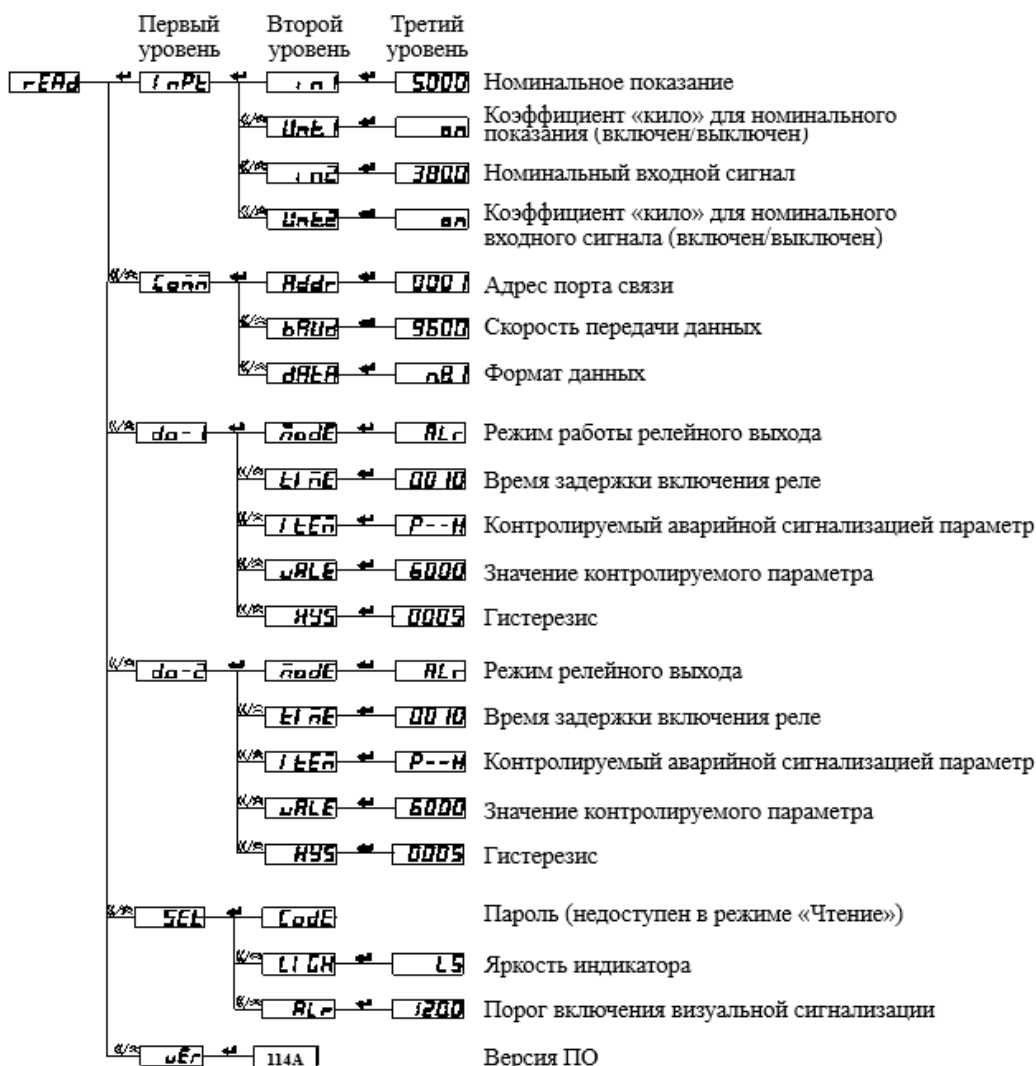
Рисунок 4.19 – Структура меню 1-канальных приборов PA194(5)I-K1-1100, PZ194(5)U-K1-1100 в режиме чтения
