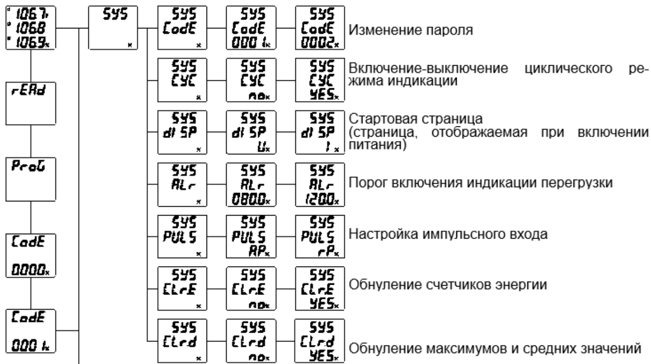
Рисунок 4.37 – Структура меню прибора PD194E-8. Начало.
