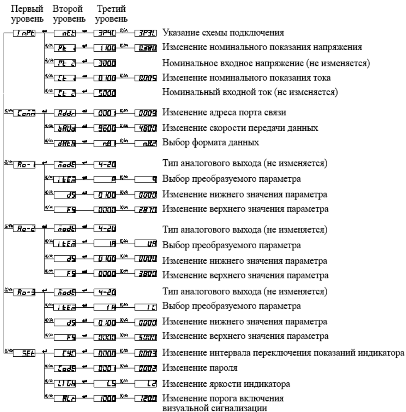
Рисунок 4.25 – Структура меню программирования 3-фазных приборов модификаций PA194(5)I-K4(3)-0030, PZ194(5)U-K4(3)-0030, PD194UI-K4-0030
