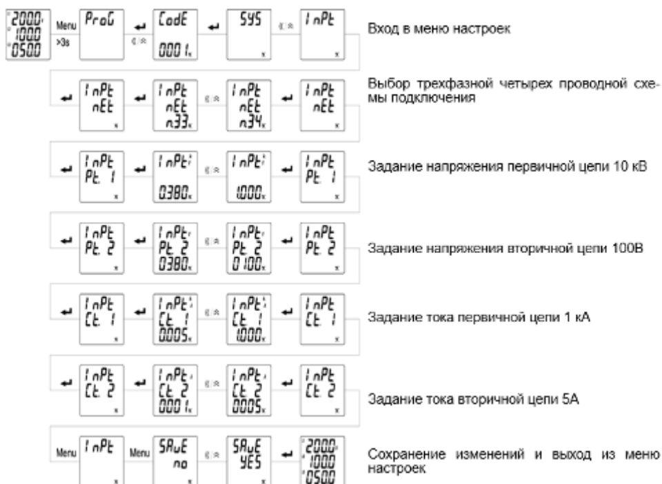
Рисунок 4.66 – Настройка параметров входных сигналов прибора PD194E-8
