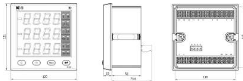
Рисунок 3.4 – Внешний вид и размеры прибора PD194PQ-2K4T-00301
