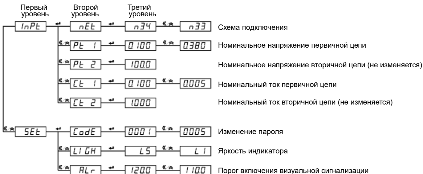
Рисунок 4.30 – Структура меню программирования ваттметров (варметров) модификаций PS194P(Q)-□X1□-0000□
