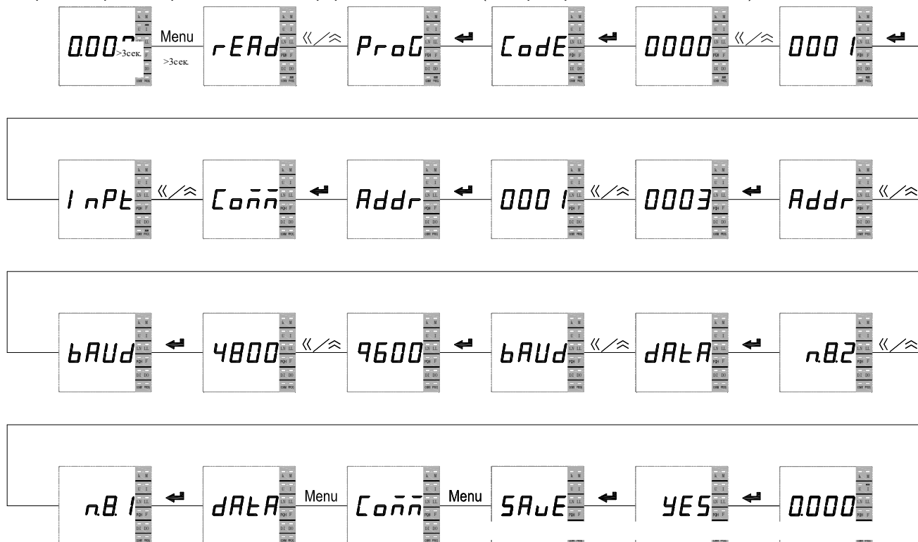
Рисунок 4.44 – Диаграмма установки параметров порта связи прибора с 1-строчным индикатором
