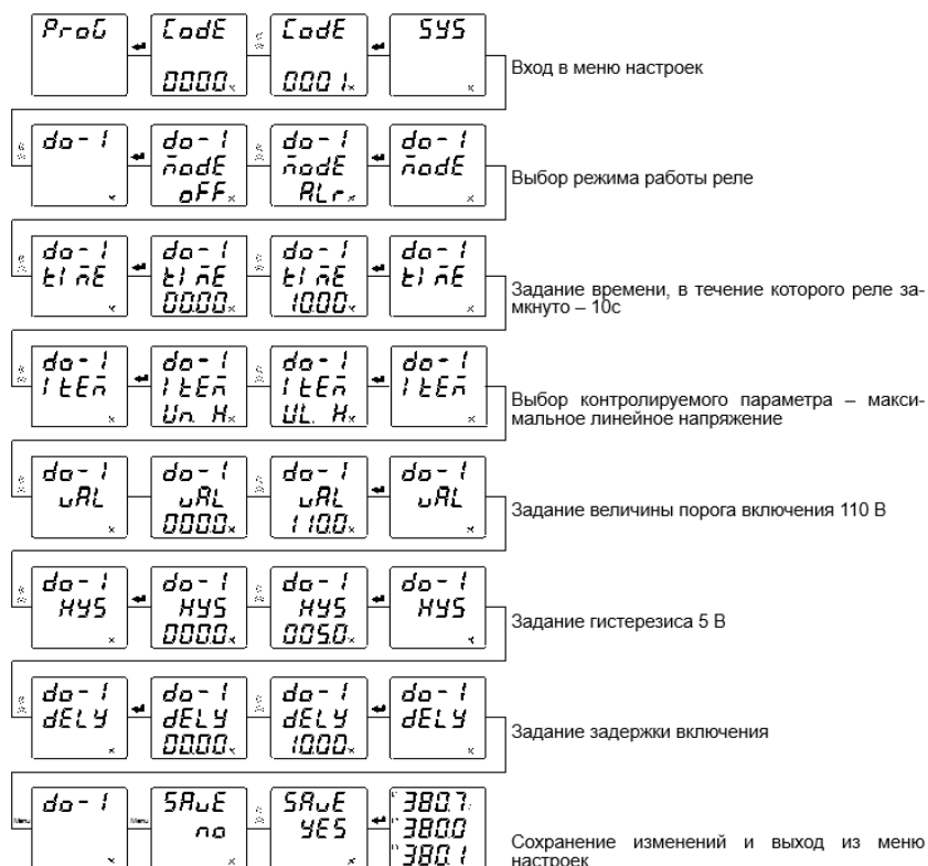
Рисунок 4.68 – Настройка релейного выхода прибора PD194E-8
