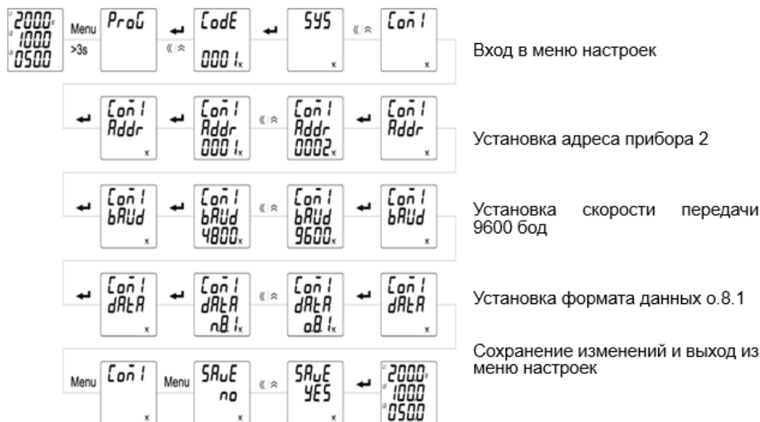
Рисунок 4.67 – Настройка параметров порта RS-485 прибора PD194E-8
