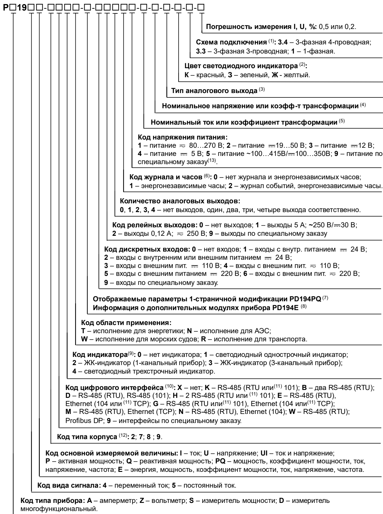
Рисунок 2.1 – Структура условного обозначения модификаций прибора
