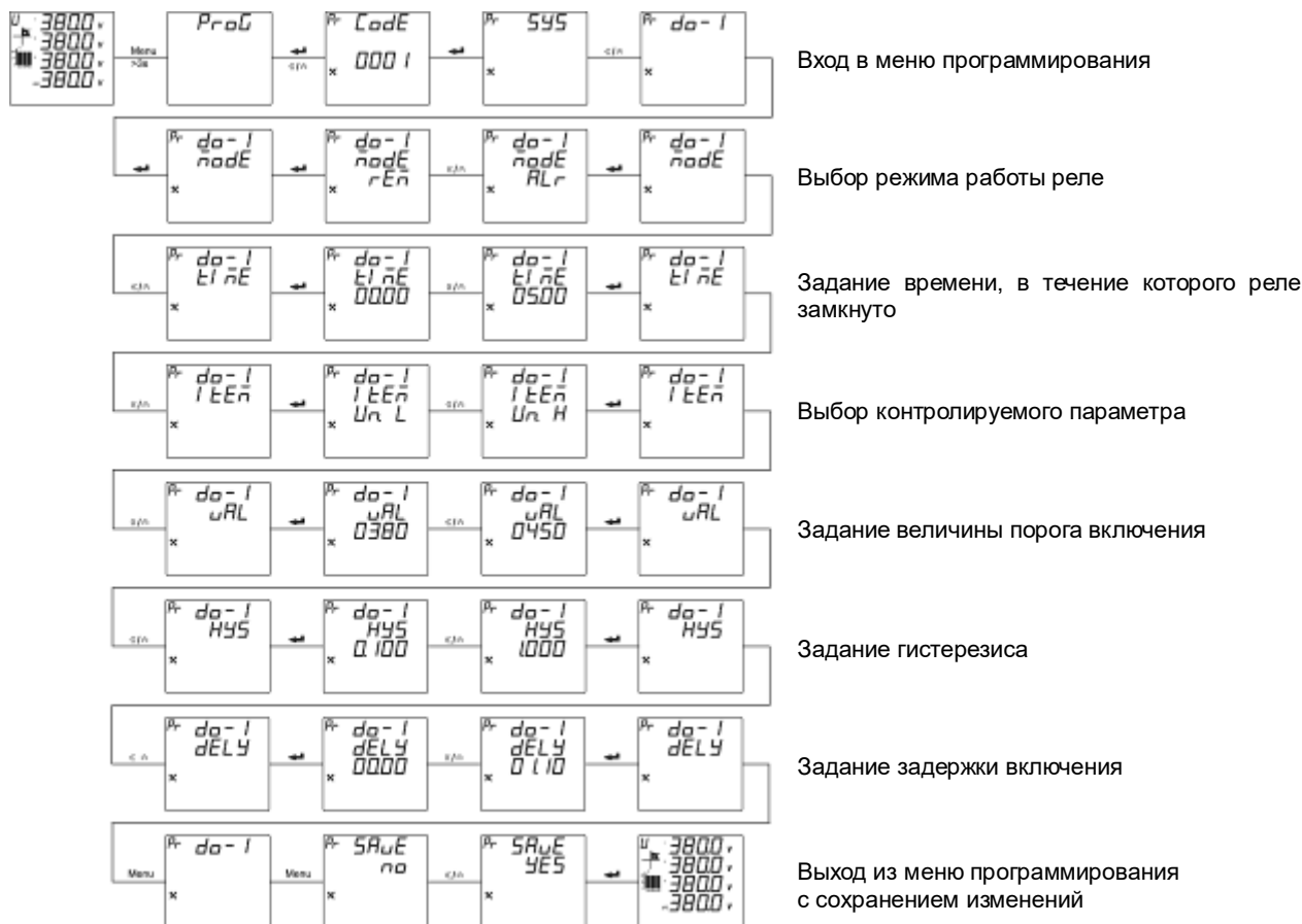
Рисунок 4.63 – Настройка релейного выхода прибора PD194E с ЖК-индикатором (модификация PD194E-9□3□)
